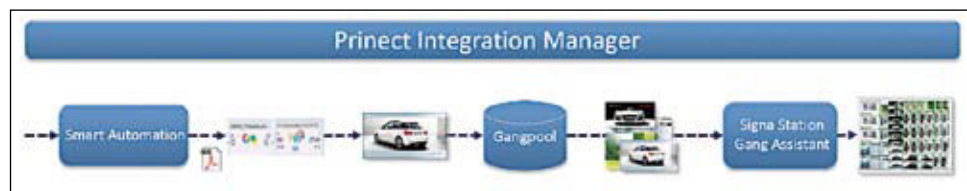
Schéma slučování W2P zakázek do tiskových forem – i do několika tiskových archů
