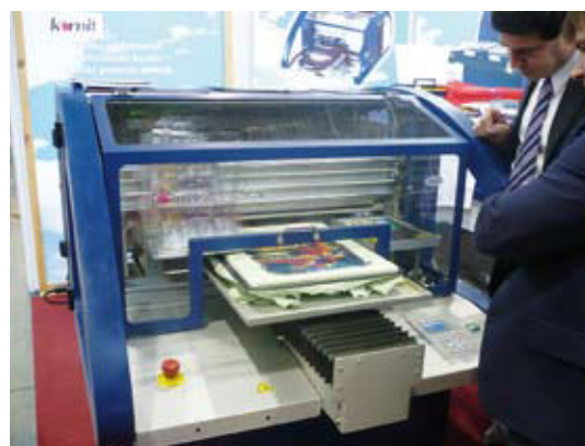
Finish v.o.s. digitální potisk textilu na stroji Kornit
